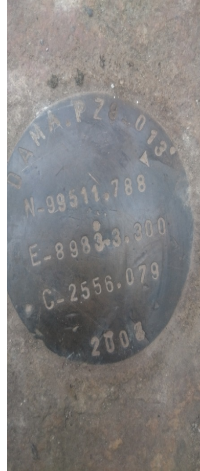
Foto 5. Placa de identificación DAMA del pozo pz-19-0009
